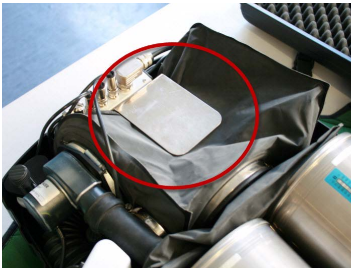
Fig. 48 Blokkere overskuddsventilen på utåndingsbagen
