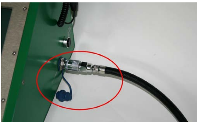
Fig. 38 Koble til middeltrykkslange
