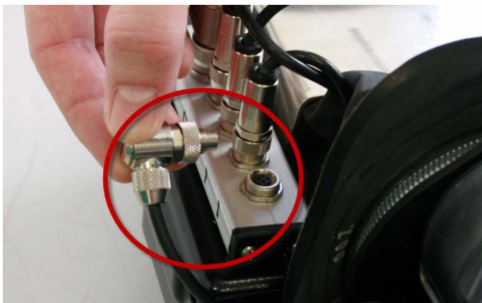
Fig. 43 Koble batteriet fra pusteapparatet med lukket krets
