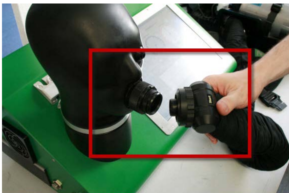
Fig. 47 Koble pusteslangesettet til testhodet
