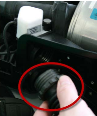
Fig. 46 Skru adapteren inn i utåndingssiden
