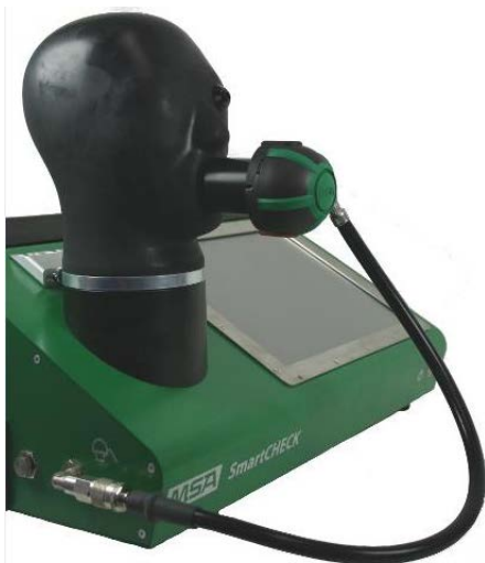
Fig. 33 Koble til lungeautomaten
