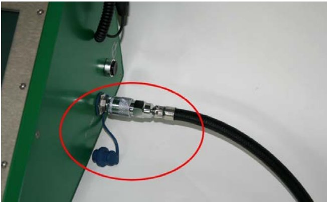
Fig. 31 Koble til middeltrykkslange
