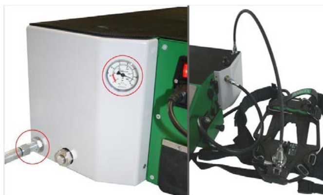
Fig. 36 Koble til høytrykkslangen
