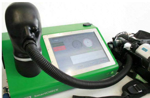
Fig. 44 Koble adapterslangen til testhodet.
