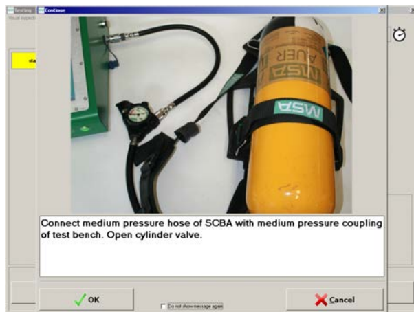
Fig. 37 Koble til pressluftapparatet.
