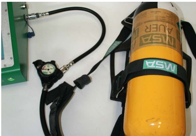
Fig. 35 Koble til pusteapparat
