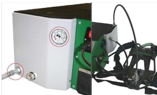
Fig. 32 Koble til høytrykkslanger
