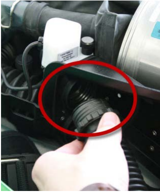
Fig. 45 Skru adapteren inn i innåndingssiden
