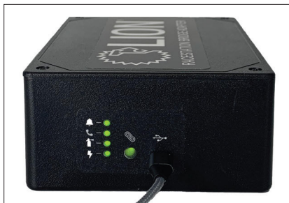
FIGUR 1: STATUSINDIKATORER FOR NETTVERKSBRO-ADAPTER
