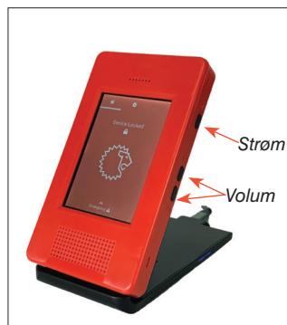
FIGUR 7: INTERAKTIV NØDTELEFON PÅ TRÅDLØS LADESTASJON
