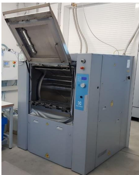
Electrolux Professional programmerbar vaskemaskin kan brukes til å vaske pustemasker med Lejon Kemi sitt vaskemiddel FPG Wash, vaskeposer og spesialtilpasset program for dekontaminering av pustemasker.
