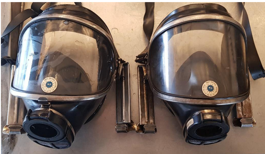
Pustemasken til venstre er rengjort med Lejon Kemi-produkter og -program, mens masken til høyre er vasket med vanlig maskinoppvaskmiddel og standardprogram.
